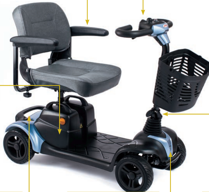
Baterías extraíbles para facilitar su recarga
