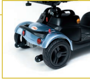
Palanca de desembrague y ruedas antivuelco
