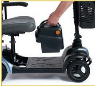
Baterías extraíbles para facilitar su recarga
