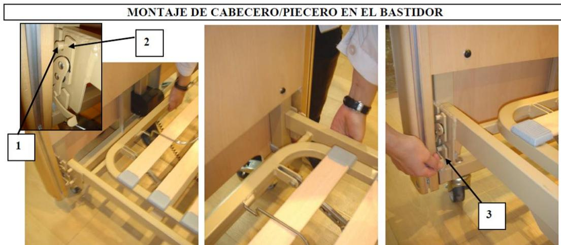
Levantar el bastidor y colocar los dos ejes (1) en las ranuras del anclaje (2) de ambos lados del cajón de madera. Asegurar el conjunto girando el pestillo (3) de seguridad hacia fuera.
